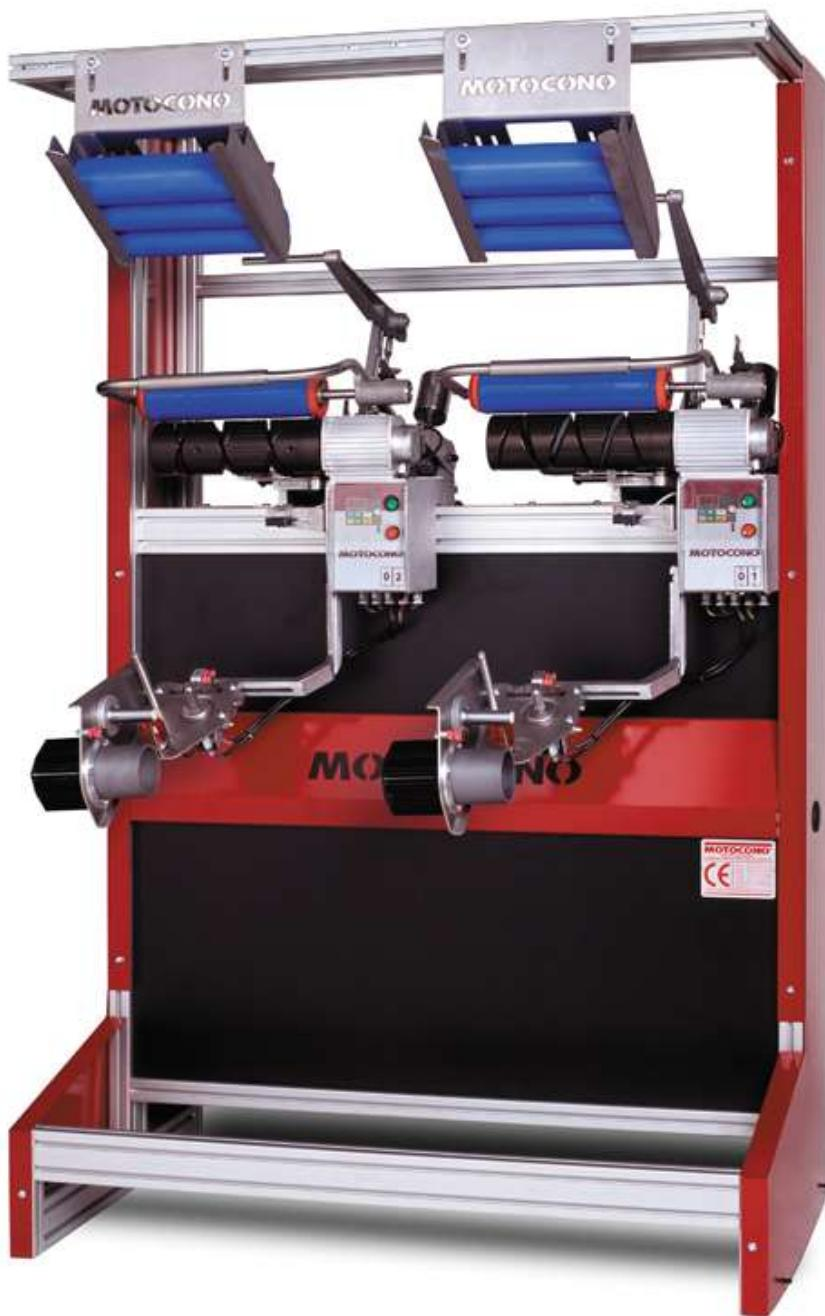
Bobinadora con descarga automática de conos ó bobinas cilíndricas, especialmente concebida para recoger los hilos acrílicos de la máquina de retracción. La bobinadora está equipada con un variador de frecuencia, que permite un ajuste de velocidad lineal desde 0 a 1.000 M/MIN. Cada cabezal cuenta con su propio motor así como de alimentador positivo de hilo para compensar la tensión a que vienen sometidos los hilos.
