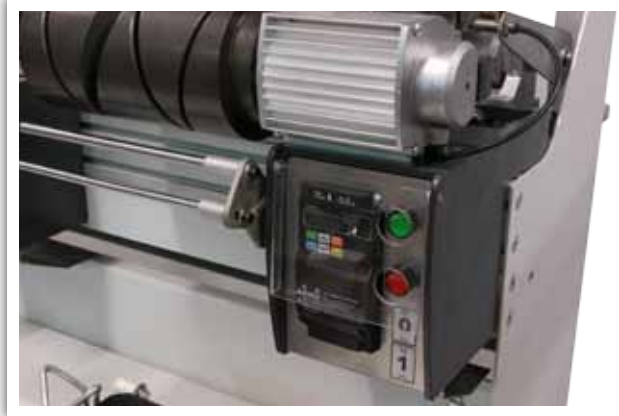
Motor y variador de velocidad de corriente alterna individual para cada cabezal Moteur et variateur de vitesse de courant alternatif individuel pour chaque broche Motor and variator of speed individual for each spindle Motore ed variatore di velocità di corrente alternata individuale per ogni testa
