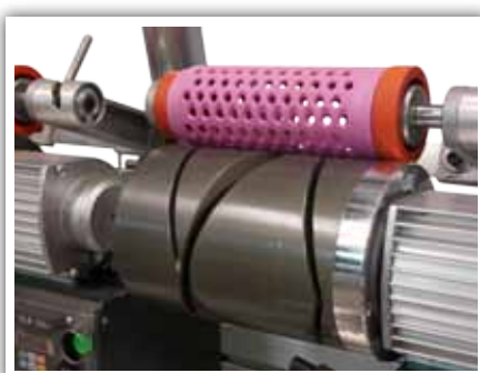
Cilindro guía hilos de gran diámetro Cylindre guide-fils à grand diamètre Grooved drum of large diameter Cilindro guida-filo di gran diametro
