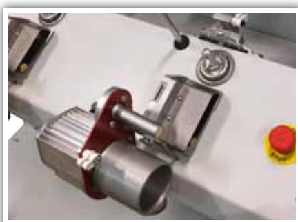
Movimiento lateral para evitar cantos duros Mouvement de va et vient pour éviter les bords de cônes plus durs Lateral movement to avoid hard edges Spostamento assiale
