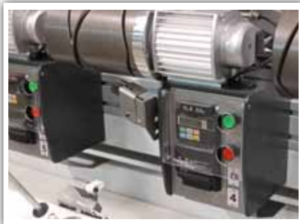
Motor y variador de velocidad de corriente alterna individual para cada cabezal Moteur et variateur de vitesse de courant alternatif individuel pour chaque broche Motor and variator of speed individual for each spindle Motore ed variatore di velocità di corrente alterna individuale per ogni testa
