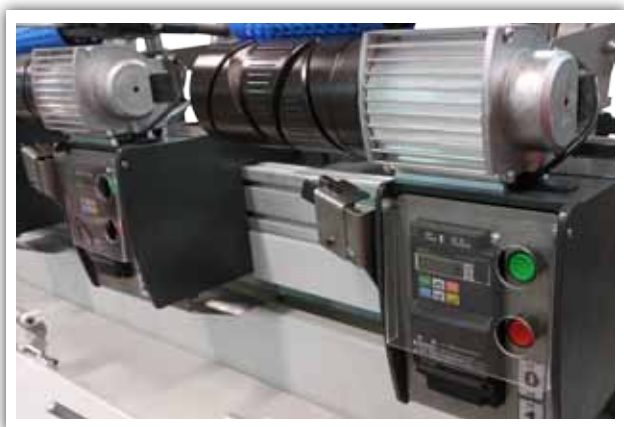
Motor y variador de velocidad de corriente alterna individual para cada cabezal Moteur et variateur de vitesse de courant alterne individuel pour chaque broche Motor and variator of speed individual for each spindle Motore e variatore di velocità di corrente alterna individuale per ogni testa
