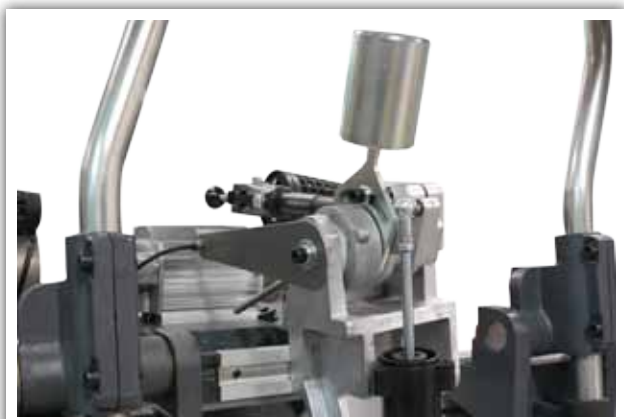
Controles de presión y vibración Control de presión et vibration Pressure and vibration controls Controlli di pressione e vibrazione
